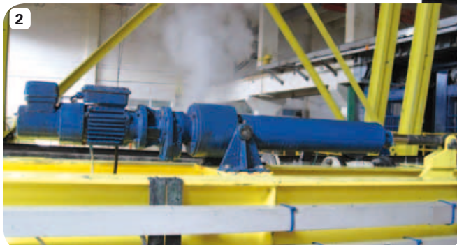
[1]-[3] Typ: T1M5 / T1M6 Betätigung der Greifer-Verriegelung in einer Galvanik-Anlage
