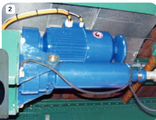
Hubbrücke Spitzenverriegelung, Typ: K1N7, Hub = 200 mm
