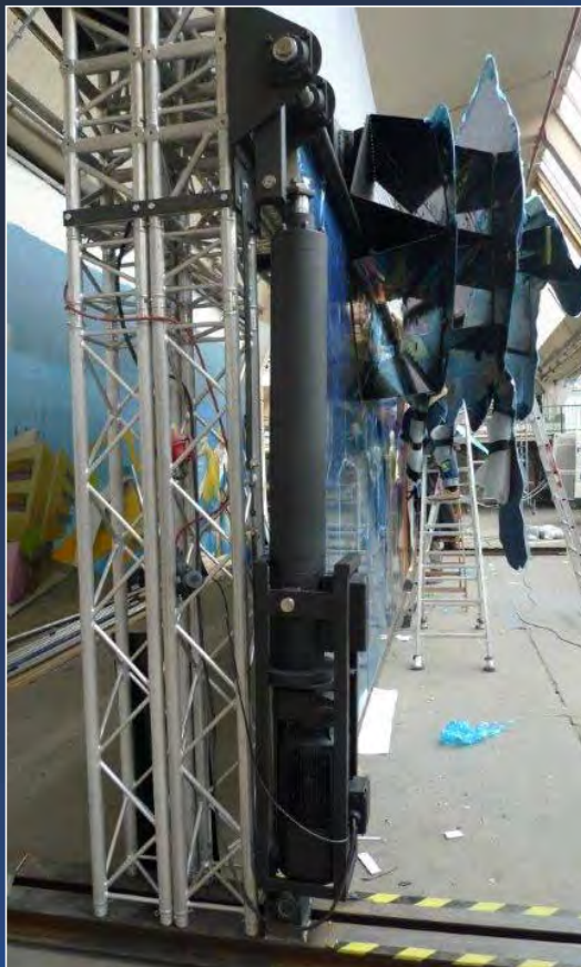
RACO Elektrozyylinder zum Öffnen des Tores
